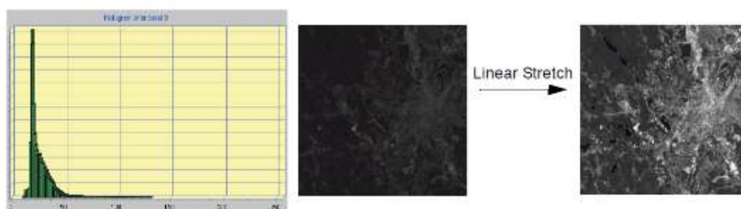
Σχήμα 2.7: Βελτίωση εικόνας με γραμμική διάταση της αντίθεσης.
